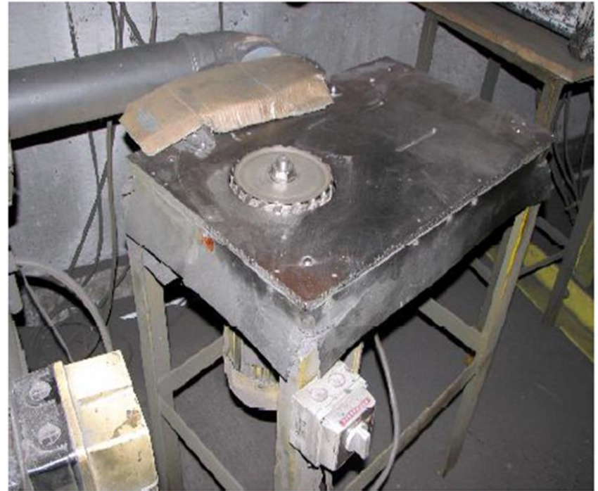
Védőburkolat nélkül, magas fordulaton üzemelő ívelő-csiszológép
