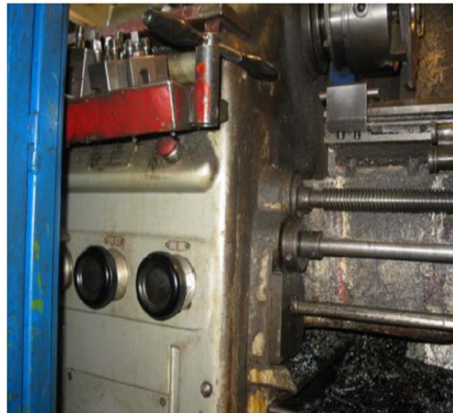
Esztergagépen a szerszámtartó alatt „eldugott” vészeállító nyomógomb
