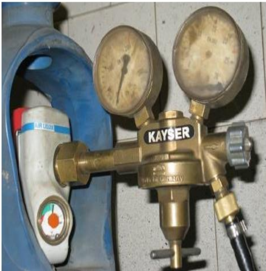
Tengelyéről elvált mutatójú nyomásmérő óra
