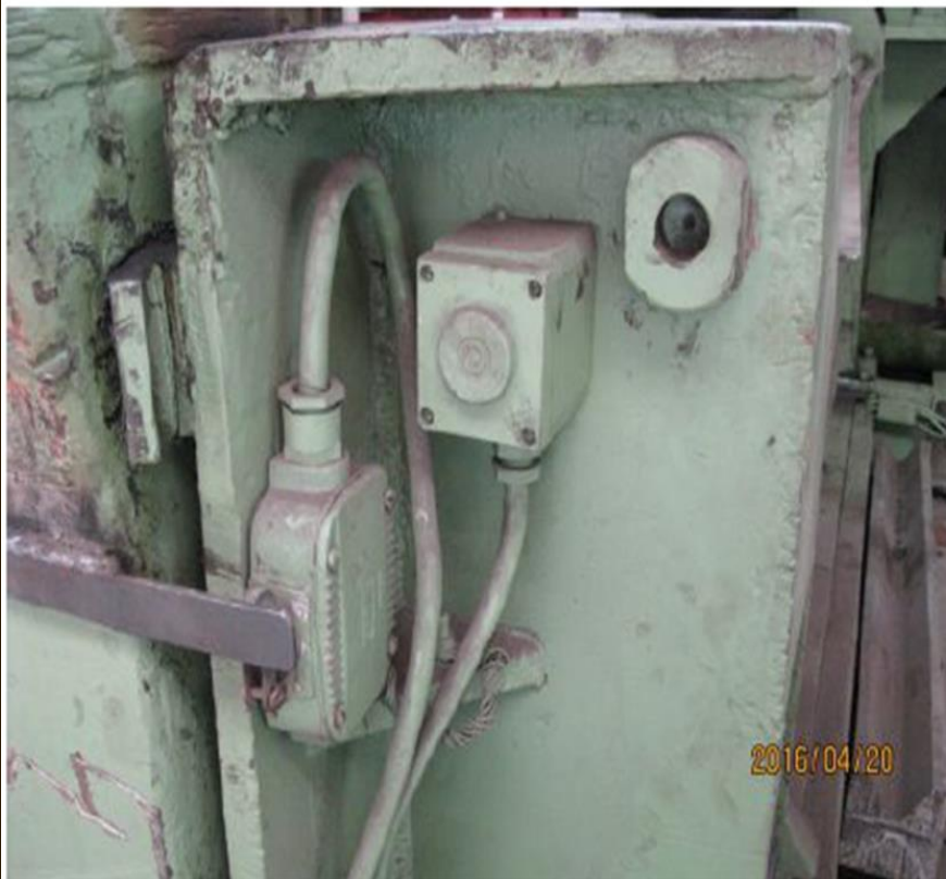
Táblalemez hengerítő gép „terepszínű” vészeállítóval
