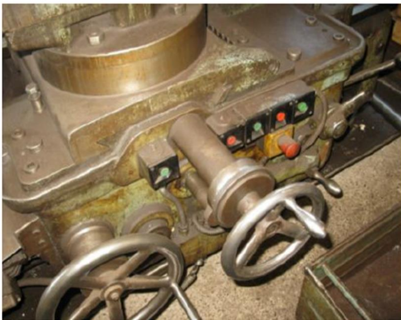
Egyetemes esztergagépen funkció jelölés nélküli kezelőszervek.
