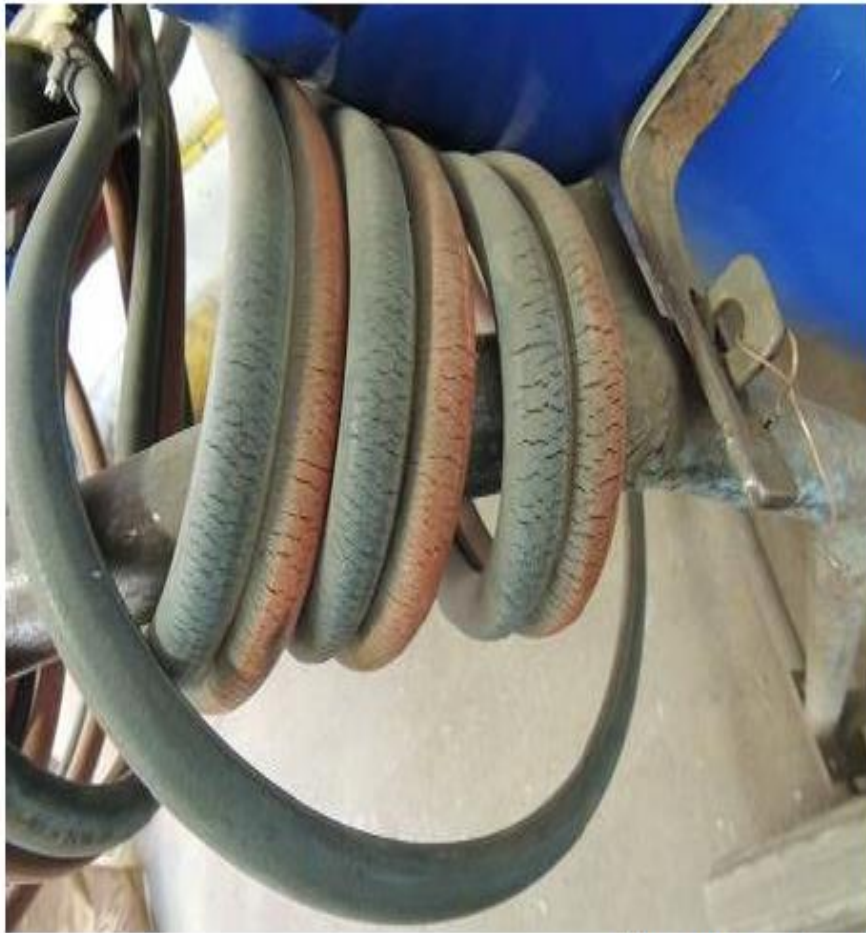
Repedezett, sérült hegesztő tömlők
