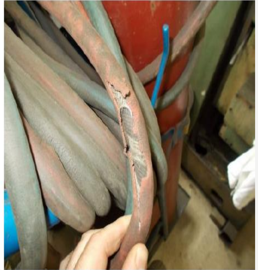
Repedezett, sérült hegesztő tömlők
