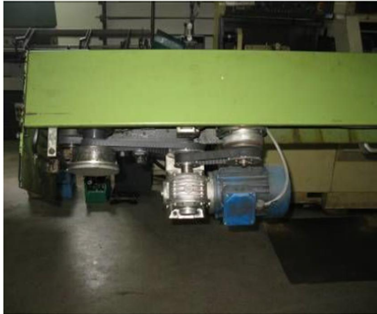
Hosszúanyag adagoló egység ékszíjhajtása burkolat nélkül
